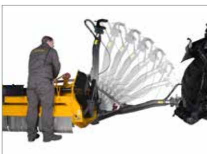
Rapidement opérationnel : dételer la machine, mettre en position de travail le dispositif de transport en long / atteler le MU-Farmer® 670 au tracteur au moyen de la barre à raccord rapide et raccorder l'arbre de transmission.
