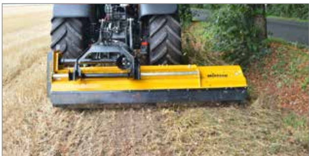
Déport latéral hydraulique : broyage déporté à côté du tracteur pour plus de flexibilité autour des arbres, des entrées ou autres obstacles (en option).
