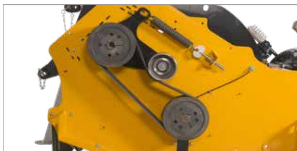
Travail sans encombre et nécessitant peu d'entretien grâce au tendeur automatique de courroie.
