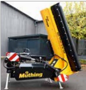
Grâce à sa conception étudiée, le broyeur peut être replié pour un faible encombrement d'entreposage.
