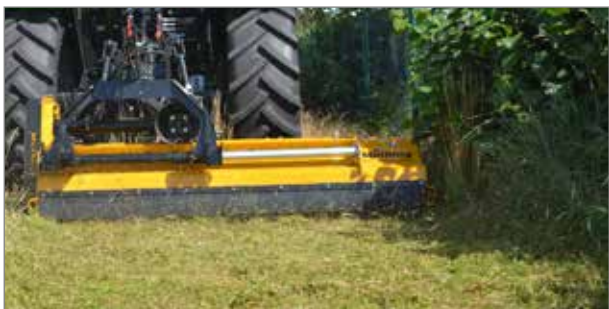
Déport latéral hydraulique : broyage déporté à côté du tracteur pour plus de flexibilité autour des arbres, des entrées ou autres obstacles (en option).
