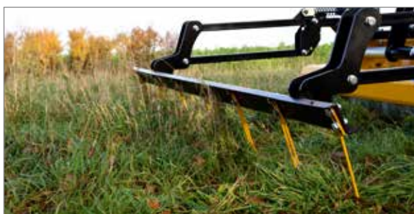
Sauveteur d'insectes : grâce à un étrier spécialement conçu, à repliage hydraulique, à dents coudées intégrées, les insectes et les micro-organismes sont chassés devant le broyeur et poussés à prendre la fuite. (en option pour des largeurs de travail de 1,60 m et 2,20 m)
