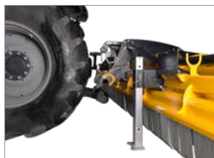
Rapidement opérationnel : dételer la machine, mettre en position de travail le dispositif de transport en long / atteler le MU-Farmer® 670 au tracteur au moyen de la barre à raccord rapide et raccorder l'arbre de transmission.
